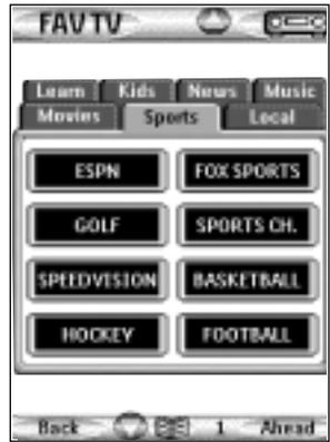
2. Die Fernbedienung RC9200/5200 springt zu dem Fenster, in dem die Makros der Sportkanäle angezeigt werden.
