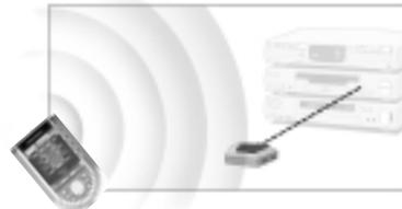
Die von der Fernbedienung ausgesendeten Hochfrequenzsignale werden von der RF-77-RF-Erweiterung aufgefangen. Die Hochfrequenzerweiterung wandelt Hochfrequenzsignale in Infrarotsignale um und sendet die Infrarotsignale an das entsprechende Gerät. Daher muss die Hochfrequenzerweiterung in der Nähe des Geräts so aufgebaut werden, dass das sendende Auge der Hochfrequenzerweiterung auf das Gerät zeigt, das Sie bedienen möchten.
