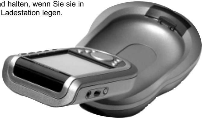
Die Aufladung startet sofort. Die grüne LED für die Aufladung an der Vorderseite der Ladestation zeigt an, dass die Batterien geladen werden. Wenn die Batterien der Fernbedienung vollständig aufgeladen sind, geht die LED aus.
